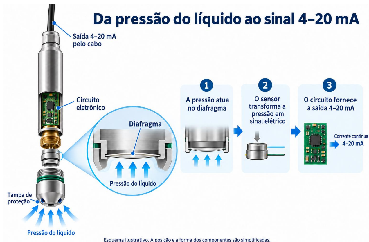
Figura 2.1 — Da pressão do líquido ao sinal 4–20 mA.
